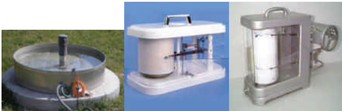
Figura 59 - Tanque Evaporimétrico, Termógrafo e Termohigrógrafo
